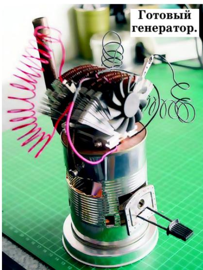
Вырежьте из текстолита или подобного материала кружок того же диаметра, что и жестяная банка. Прорежьте отверстие в прокладке таких размеров, чтобы элемент Пельтье мог в нем поместиться. Соберите все вместе. Прикрепите пружины к верхней части банки, пропустив каждый болт через конец пружины, гайку, банку и другую гайку внутри банки. Затем присоедините радиатор к вентилятору от компьютера или какому-либо другому, работающему от 5 В, с помощью тонкой медной проволоки, клея или винтов.
