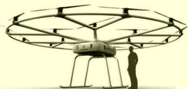
Элементы корпуса и винты аппарата VoloDrone, недавно представленного немецкой фирмой e-voLo, изготовлены из композитных материалов. Питание для электродвигателей может быть как исключительно от литиевых аккумуляторов, так и от гибридной силовой установки с ДВС и электрогенератором. Винты разнесены на достаточное расстояние, что исключает возможность их перехлеста.
