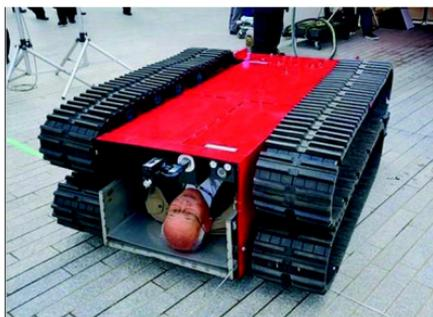
Австрийскую разработку LUF 60 отличает не только способность гасить огонь, но и удалять продукты сгорания с места пожара. Робот удаляет дым мощным потоком воздуха, тушит огонь на расстоянии до 60 м (суммарный объем запаса воды 2,4 т), может подниматься по неровным поверхностям с углом до 30° на скорости 6 км/ч.
